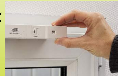
Abb. 33: Einstellung der Zeitscheibe im Uhrzeigersinn
