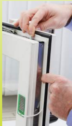
Abb. 31: Kabel seitwärts legen und mit Klebeband fixieren
