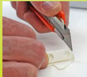
Abb. 7: Montagehilfe 'Segel' (D1) der Fensterrahmen-Halterung (D) abschneiden
