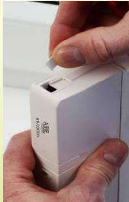
Abb. 21/22: Schutzabdeckung 'RS' ausbrechen
