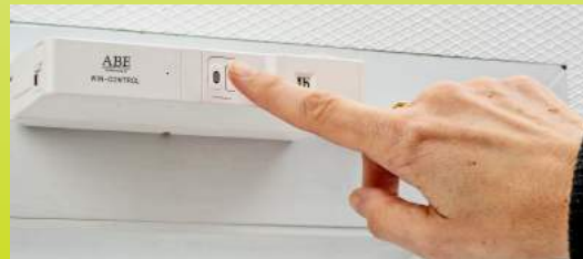
Abb. 35: Betätigung der Schließaste (A5)
