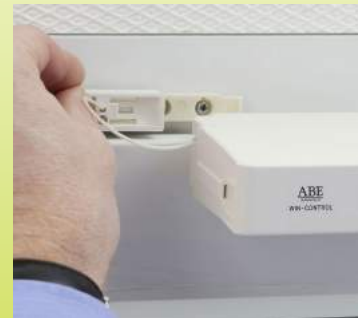
Abb. 36: Entfernen des Clip (A1)
